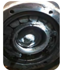
軸承摩擦損壞
